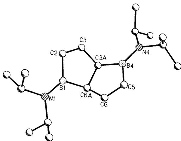
Abb. 1. Struktur von einem Molekül **1** im Kristall; ausgewählte Bindungsabstände [pm]: B(1)–C(2) 153.8(7); C(3A)–C(6A) 155.8(6); B(1')–C(6A') 161.0(6); C(3A')–B(4') 159.0(7); B(4')–C(5') 154.6(7); B(1)–C(6A) 159.4(7); C(3A)–B(4) 159.6(7); B(4)–C(5) 154.6(7); B(1')–C(2') 155.0(7); C(3A')–C(6A') 155.5(5)
